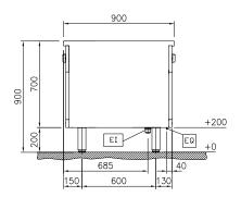
Electrical inlet (power) **Equipotential screw**
